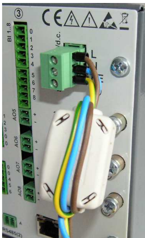
Rys. 1.1. Podłączenie filtra sieciowego.
