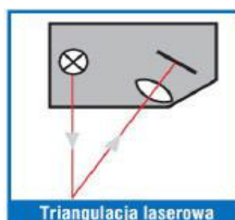
Rys.2. Zasada działania czujnika laserowego triangulacyjnego [2]
