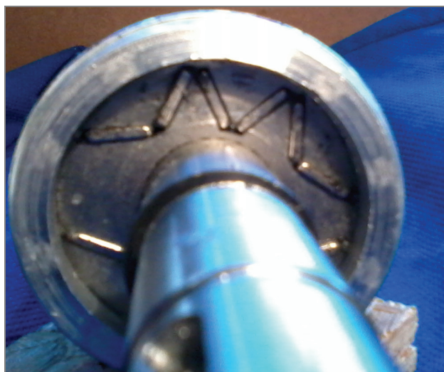
Rys. 3. Rozmieszczenie magnesów trwałych w wirniku badanego silnika synchronicznego
