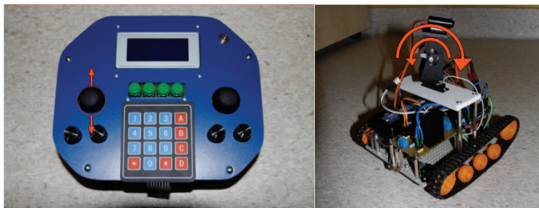
Rys. 9. Obrót platformy wokół osi poziomej
