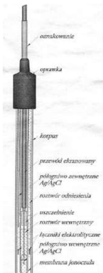
Rys.D1. Elektroda zespolona typu ERH-111
