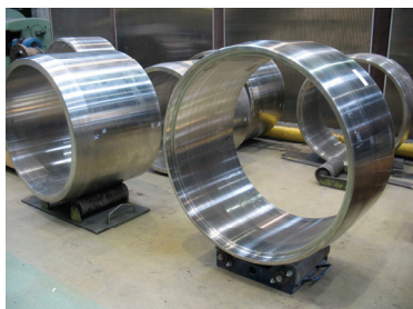
Rys. 2. Widok kołpaków na stanowisku do badań nieniszczących Fig. 2. View of retaining rings at the non-destructive tests stand
