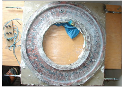
Rys. 6. Stojan zalany żywicą Fig. 6. Stator spilled with resin
