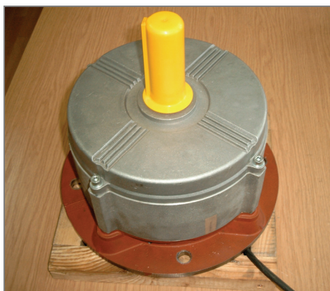
Rys. 3. Widok wykonanego prototypu prądnicy Fig. 3. The view of the prototype of generator
