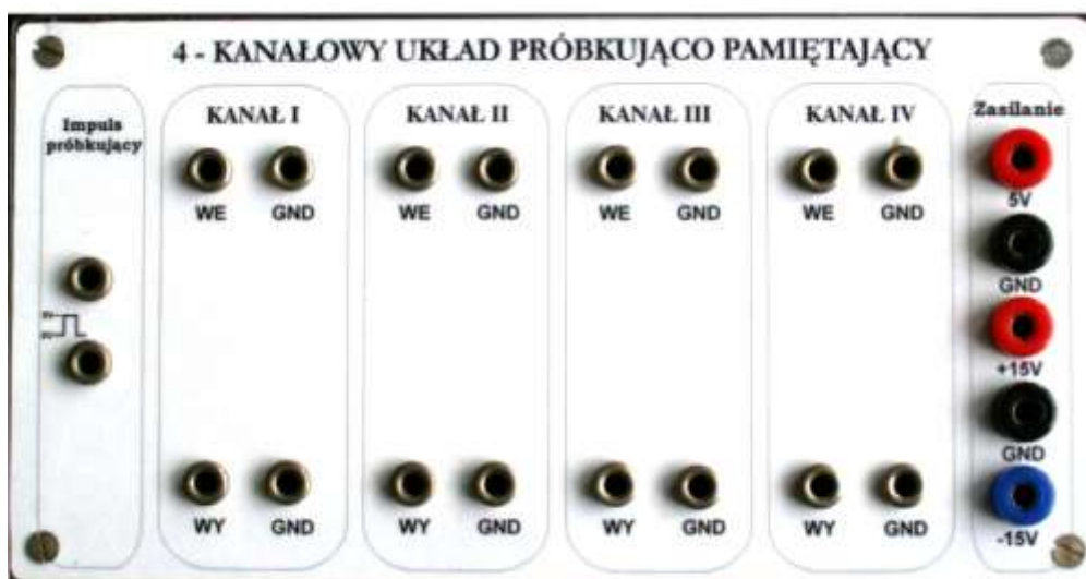
Rys. 12. Zdjęcie płyty czołowej obudowy układu próbkująco-pamiętającego
