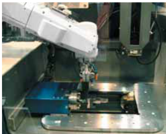
Rys. 1.4. Przykład zastosowania robota RV-3SB w obrabiarce do obróbki elektroiskrowej
