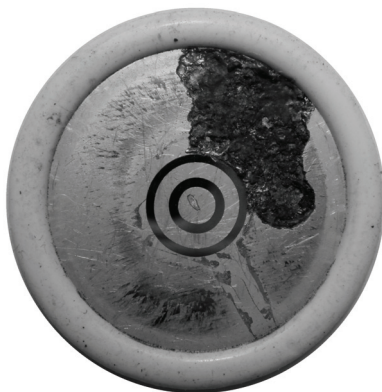
Rys. 12. Uszkodzona płytkę krzemowa tyrystora
